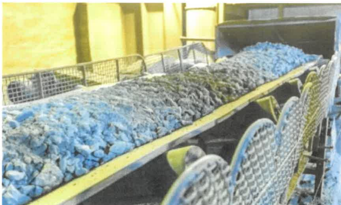
Сурет 3 – ББФ-дағы ұсақталған кен бөлшектерін майдалауға жөнелту
